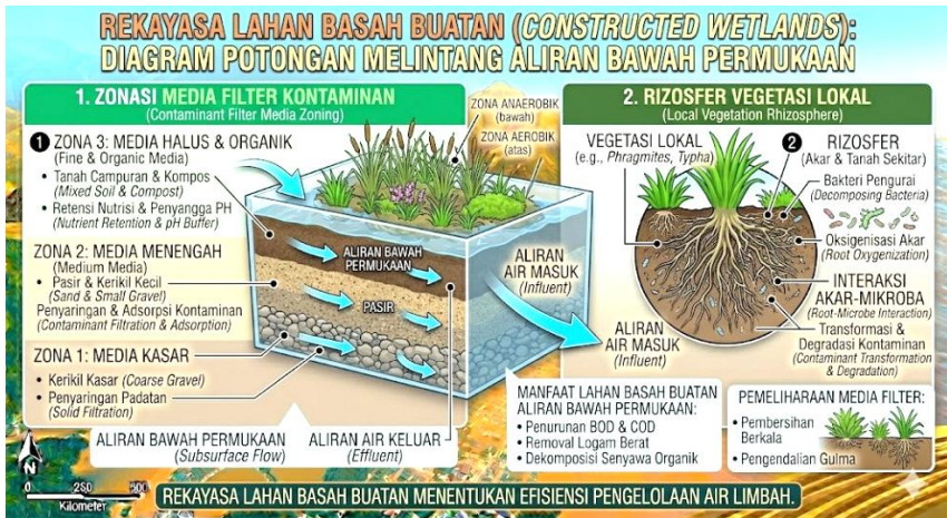
Gambar 5. 3 Diagram potongan melintang rekayasa Lahan Basah Buatan (Constructed Wetlands) aliran bawah permukaan, menampilkan zonasi media filter kontaminan dan rizosfer vegetasi lokal.
