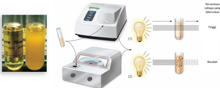
Gambar 10. Pengukuran turbiditas menggunakan spektrofotometer (Cowan, 2012)
