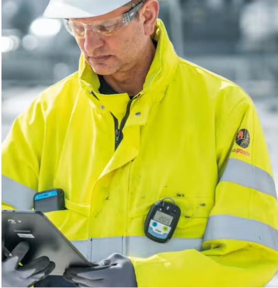
Gambar 9. 18 Gas Detector Portable Berfungsi sebagai Pengaman Pekerja yang Dapat Dikirimkan Melalui Cloud
