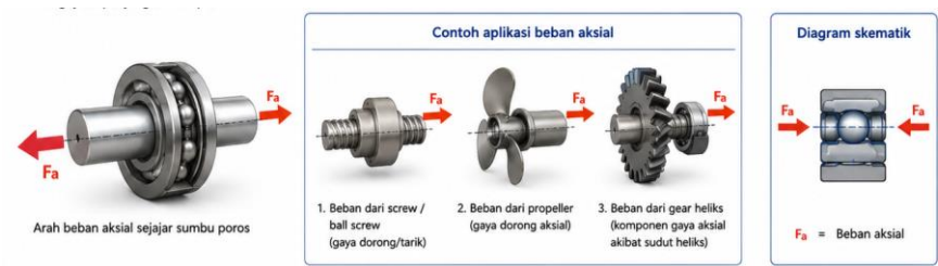
Gambar 6. 8. Beban Aksial Pada Bearing
