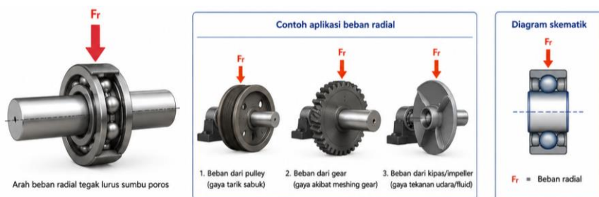
Gambar 6. 7. Beban Radial Pada Bearing
