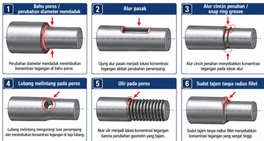
Gambar 5. 5. Beberapa Sumber Konsentrasi Tegangan Pada Poros.
