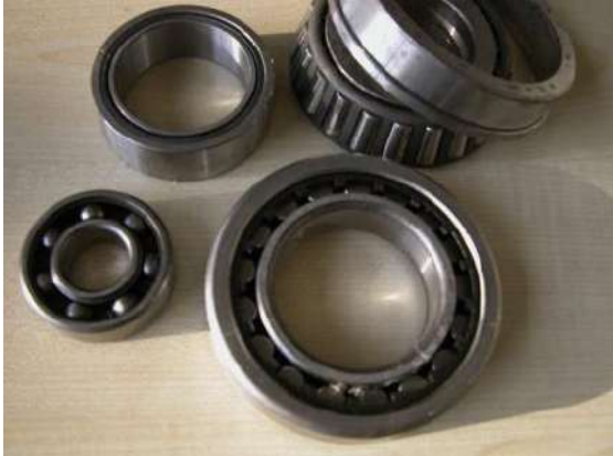
Gambar 3.8. Contoh bantalan roll yang banyak tersedia di pasaran Sumber : (Childs, 2014)
