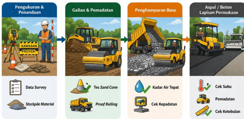
Gambar 8.2. Tahapan Pekerjaan Perkerasan Lentur dan Quality Control di Lapangan (Sumber: Ilustrasi Penulis, dibuat dengan ChatGPT, 2026)
