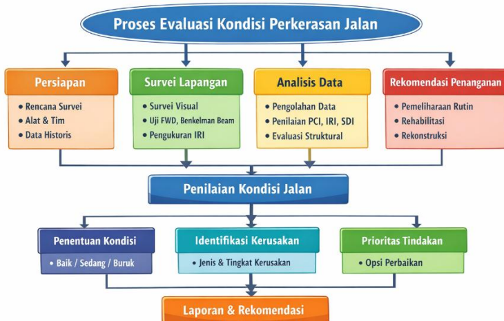
Gambar 10.1. Proses Evaluasi Kondisi Perkerasan Jalan Sumber: Hasil olahan berdasarkan ASTM (2012), Bina Marga (2017), Shahin (2005), dan Huang (2004).
