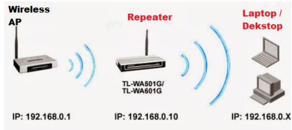
Gambar 14.13. Repeater menghubungkan dua jaringan bertopologi bus
