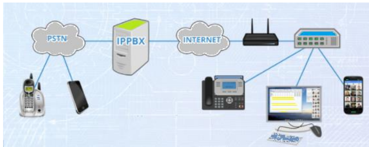
Gambar 14.7. PBX untuk menangani sistem telepon dan jaringan komputer
