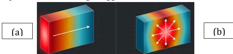
Gambar 5. 1: Perbandingan (a) Media Perantara Konduksi Biasa dan (b) Media dengan Sumber Pembangkit Panas Internal.
