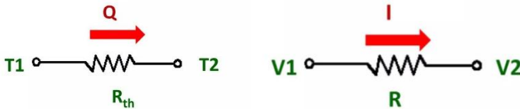
Gambar 2. 1 Analogi Rangkaian Listrik dan Thermal (Sumber : Cengel,2020)
